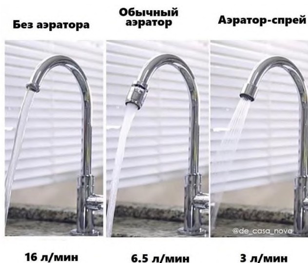
Рисунок 18. Пример расхода воды смесителем без аэратора, с обычным аэратором и с аэратором с функцией управляемой струи
